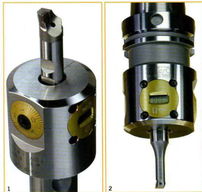
Feinbohrköpfe der Swiss Tool AG besitzen eine Digitalanzeige und ein Direkt-Wegmesssystem. Der Einstellbereich beträgt 2,7 Millimeter im Radius. Unterschiedliche Bohrstangen ermöglichen Bohrungen von drei bis 88,1 Millimeter. Der Einstell- und Anzeigebereich ist TiN-beschichtet und damit vollkommen verschleiß- und abriebfrei. Durch die Auswuchtmöglichkeit mittels Auswuchtringen sind die Köpfe für Ausspindelarbeiten bis 16000 Umdrehungen pro Minute geeignet.
