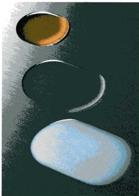
Das neue Additiv CX (Mitte) bildet mit der Leistungskomponente Hycut ET 46 (oben) eine biozid- und borfreie Hochleistungsemulsion (unten). Bild: Oemeta
