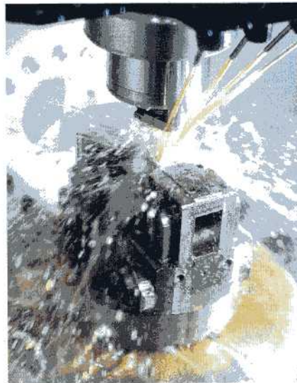
IWC fertigt in einer einzigen Aufspannung alle notwendigen Operationen wie Fräsen, Bohren, Gewindeschneiden und Einstechen sowie die Feinbearbeitung der Kanten.
