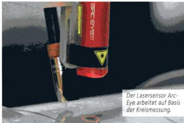
Der Lasersensor Arc-Eye arbeitet auf Basis der Kreismessung.
