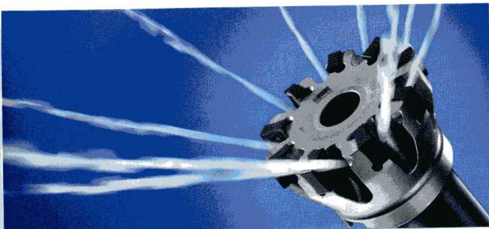
Die biozid- und borfreie Emulsion Hycut ET 46/Additiv CX dient allen Arten der Hochleistungszerspanung.
