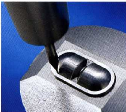
Mini-Fräser: Bearbeitung eines Pressstempels aus dem Werkstoff 1.4112 mit einer Härte von 56 HRC.
