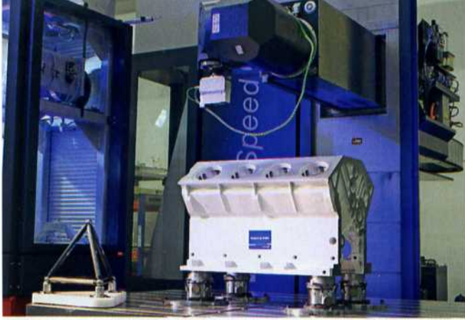
Nullpunktspannsystem mit schwimmender Lagerung in Kombination mit dem WM VSC 3D zum berührungsfreien Vermessen der Bauteile.
