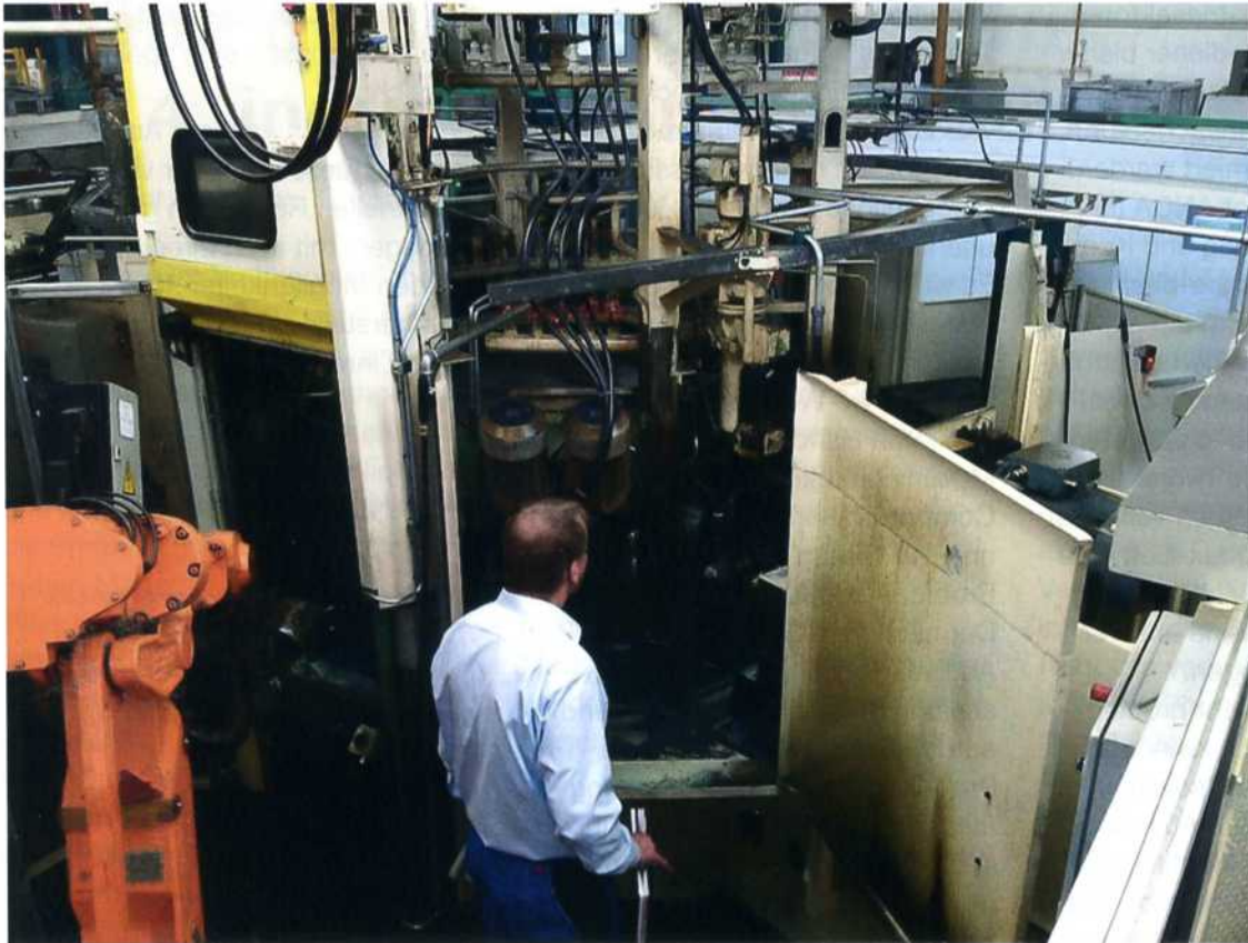
Bild 1: Mit professioneller Reinigung der KSS-Systeme sorgt Oemeta für Produk- tivitätssteigerungen durch längere Standzeiten der Werkzeuge (Werkbilder: Oemeta Chemische Werke GmbH, Uetersen)
