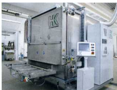
Umluftofen für die Heißumformung von flächigen und vorgeformten Composite-Halbzeugen (© HK Präzisionstechnik)
