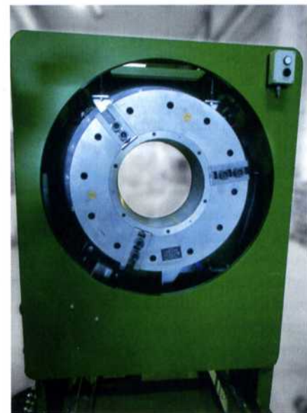
Die Kugeldrehverbindung mit einem Außendurchmesser von 329 mm ist für eine Rotationsbewegung von mehreren t verantwortlich.
