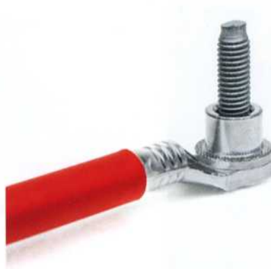
Beste Ergebnisse erzielt das Verfahren bei zylindrischen Schweißungen für runde Bolzen, Ringe oder Schrauben.
