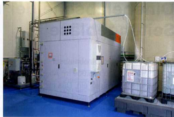
Bild 2: Die energieeffiziente vollautomatische Verdampferanlage ET 1500 von MKR Metzger kann pro Stunde 1.500 Liter Prozesswasser verarbeiten
