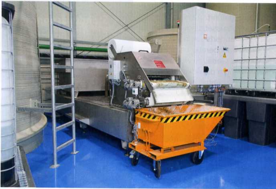
Bild 8: Die Vorfilterstation UF 700 ist ein hydrostatisch arbeitender Schrägbettfilter mit einem 4.000 Liter großen Edelstahl-Auf-fangbehälter. Der abgeschiedene Filtra-tionskuchen kann über einen kippbaren Schlammwagen bequem ausgebracht werden
