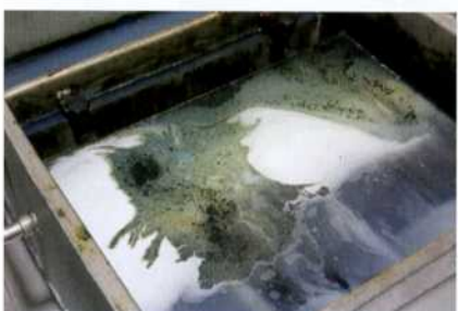
Bild 6: Der Fremdölabscheider TB 800 funktioniert nach dem Koaleszenzprinzip und trennt Prozessmedien von Fremdölen
