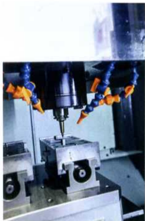
Bild 3: Vor allem die harten Materialien stellen große Herausforderungen an die Maschinen. In der HSC-Bearbeitung mit der YMC 430 sind die kleinen Stufen, die strategiebedingt beim Fräsen entstehen, deutlich präziser
