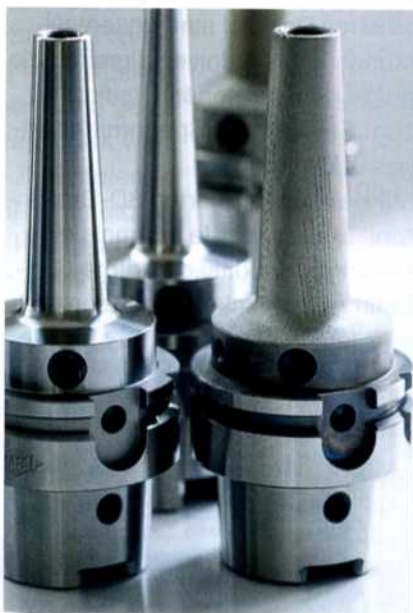
Bild 4: Auf den konventionell gefertigten Grundkörper wird per selektivem Laserschmelzen der Funktionsbereich aufgebracht (Werkbilder 3+4: Mapal, Aalen)
