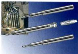
vorgeliefert wird. Betriebsspannungen von 5, 12 oder 24 V<sub>DC</sub> und der geringe Betriebsstrom ermöglichen den Einsatz auch in mobilen Systemen. Der elektrische Ausgang ist jetzt auch mit den bewährten Push-Pull-Steckverbindern möglich. Die dreipolige Einbaubuchse wird im 10 mm (Durchmesser) dünnen Gehäuse des Tasters integriert. Mit dem selbstverriegelnden System kann der Gegenstecker einfach axial in die Buchse gesteckt werden.
