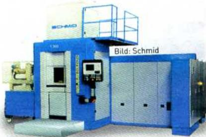
Taumelpressen produzieren Differentialkegelräder in einem Gang.
