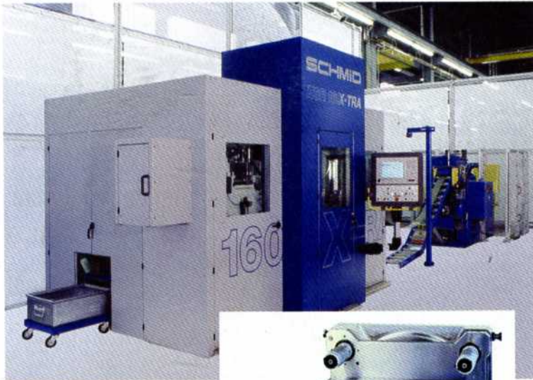
Bild 2: Innovative Pressentechnik - die erste Feinschneidpresse mit hydraulischem Servoantrieb.
