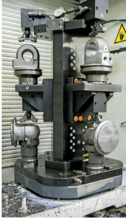
Zwei AMF-Spanntürme mit je sechs AMF-Nullpunktspannelementen auf zwei Ebenen sowie zahlreiche weitere Funktionsteile vereinfachen die Rüstvorgänge.
