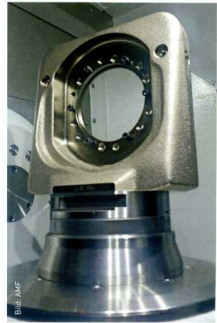
Die indixierten Rondenhalter für das Rohmaterial können verdrehsicher montiert werden. Jährlich werden damit in mannloser Fertigung rund 142 000 individuelle Zahnersatz-Exemplare hergestellt.
