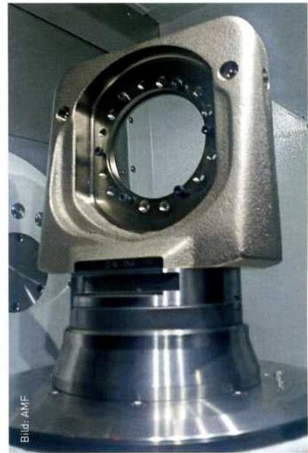
Die indexierten Rondenthaler für das Rohmaterial verdrehsicher montiert werden. Jährlich werden damit in mannloser Fertigung rund 142 000 individuelle Zahnersatz-Exemplare hergestellt.
