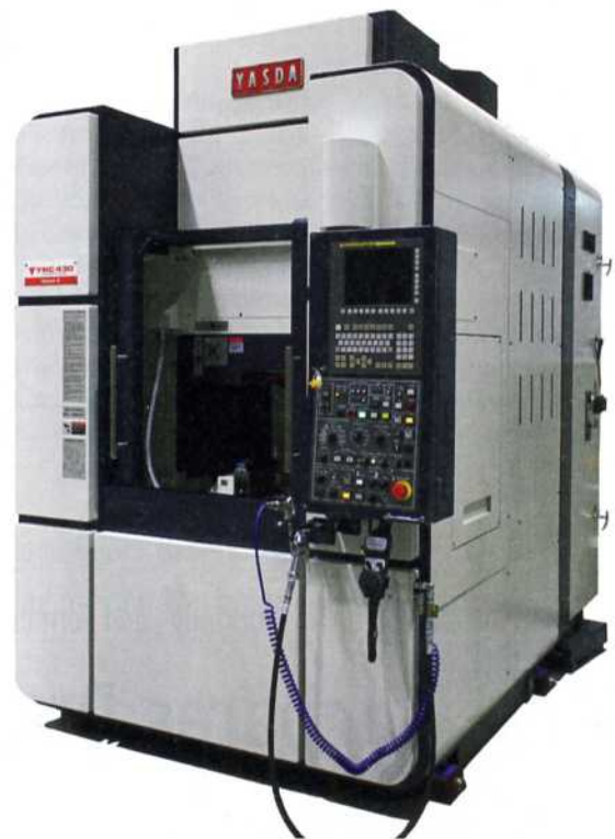
Bild 3. Hohe Steifigkeit: Das „Micro Center YMC 430“ von Yasda ist kompakt und wiegt dennoch rund 8 t. Die Führungen sind handgeschabt.
