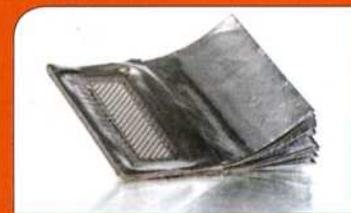
Mit dem Torsionsschweißen ist es möglich, die dünnen Folien der Folienpakete zu verschweißen, ohne dabei die empfindliche oberste Folie zu beschädigen.
