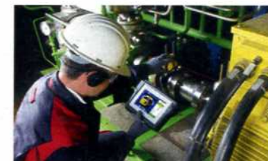
Cloudbasiertes Laserwellenausrichtsystem Rotalign touch mit neuen Funktionen
