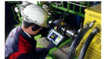
Cloudbasiertes Laserwellenausrichtsystem Rotalign touch mit neuen Funktionen
