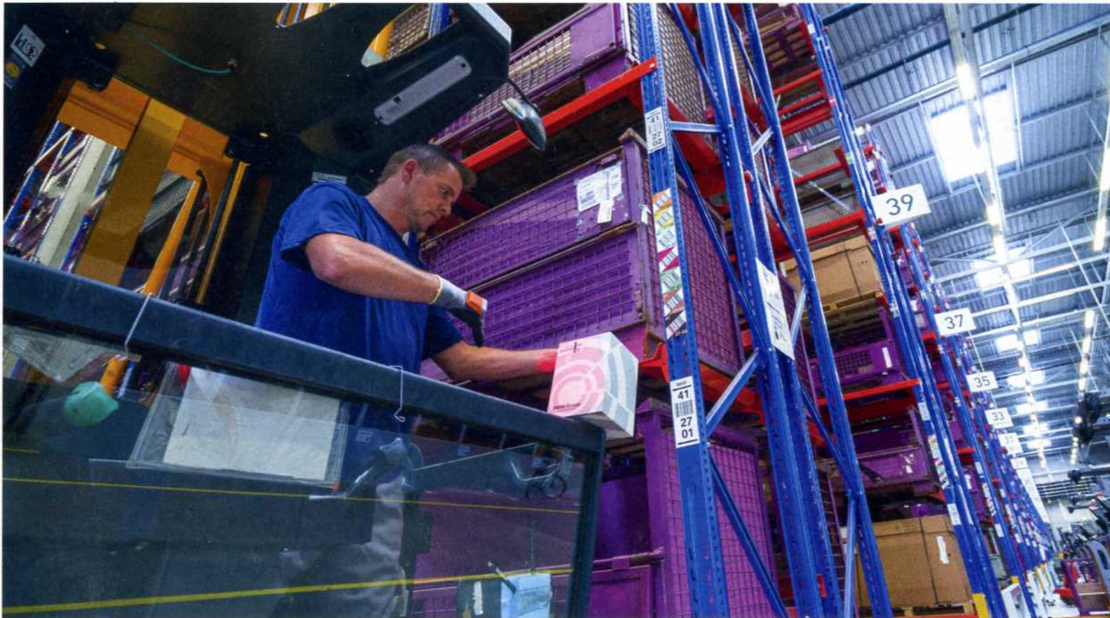
Das Scannen ist in die natürliche Handbewegung integriert. Durch optische, akustische und haptische Signale weiß der Kommissionierer, dass der Artikel korrekt erfasst wurde. Bilder: BMW
