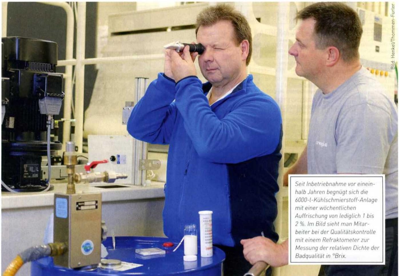
Seit Inbetriebnahme vor eineinhalb Jahren begnügt sich die 6000-l-Kühlschmierstoff-Anlage mit einer wöchentlichen Auffrischung von lediglich 1 bis 2 %. Im Bild sieht man Mitarbeiter bei der Qualitätskontrolle mit einem Refraktometer zur Messung der relativen Dichte der Badqualität in °Brix.
