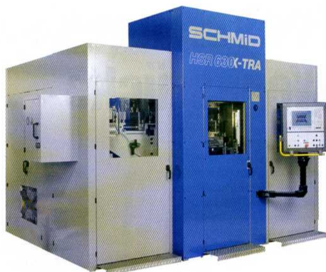
Kontrolliertes Feinschneiden mit sehr hohen Hubzahlen präsentiert die Heinrich Schmid AG mit ihrer neuen Presse HSR 630 X-TRA.
