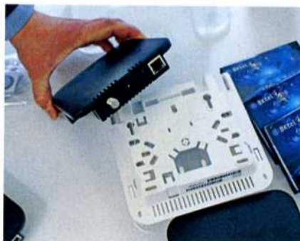
Bild 6: Lösung für die Wohnungswirtschaft: FTTH-Zugang für die Wohnung: LWL- und Kat-6 A -Anschlüsse sind vorhanden
