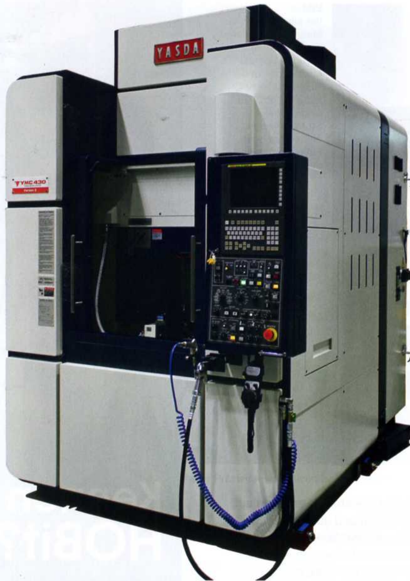
Bild 4: Hohe Steifigkeit: Das Yasda Micro Center YMC430, das TECNO.team vertreibt, ist kompakt und wiegt dennoch rund 8 t. Die Führungen sind handgeschabt
