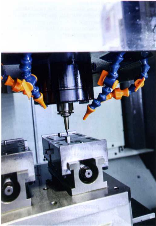
Bild 3: Vor allem die harten Materialien stellen große Herausforderungen an die Maschinen. In der HSC-Bearbeitung mit der YMC 430 sind die kleinen Stufen, die strategiebedingt beim Fräsen entstehen, deutlich präziser
