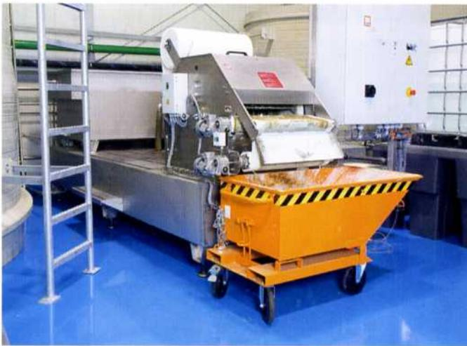
**Die Vorfilterstation UF 700 ist ein hydrostatisch arbeitender Schrägbetfilter mit einem 4.000 Liter großen Edelstahl-Auffangbehälter. Der abgeschiedene Filtrationskuchen kann über einen kippbaren Schlammwagen bequem ausgebracht werden.**
