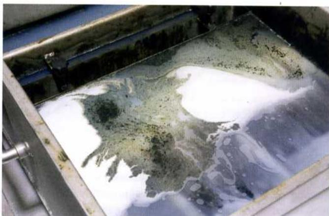
**Der Fremdölabscheider TB 800 funktioniert nach dem Koaleszenzprinzip und trennt Prozessmedien von Fremdölen.**
