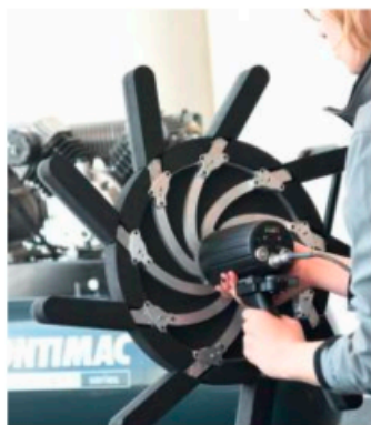
Die LMS Sound Camera gehört zum Portfolio von Simulations- und Testlösungen für Predictive Engineering Analytics.
