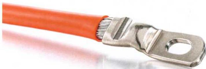
**Das torsionale Ultraschallschweißverfahren von Telsonic verschweißt Aluminiumkabel mit bis zu 200 mm<sup>2</sup> Querschnitt sicher in einem dickwandigen Rohrkabelschuh aus vernickeltem Kupfer.**
