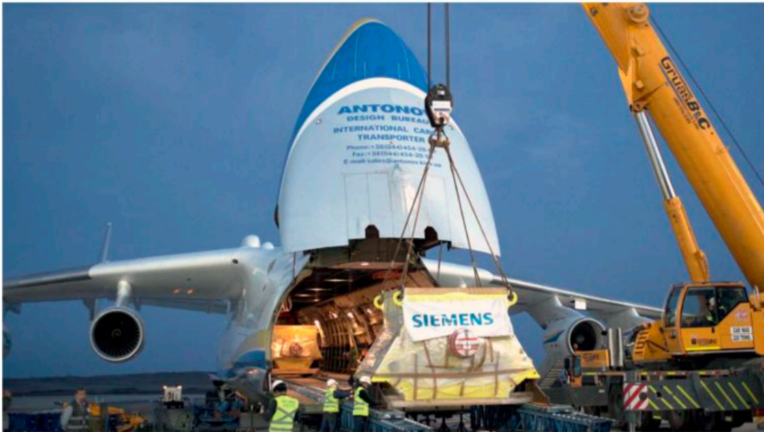
Um eine möglichst kurze Stillstandzeit zu erreichen, wurden unter anderem die neuen Antriebssysteme, die die Zuverlässigkeit der Mühlen und den Durchsatz enorm erhöhen, per Flugzeug transportiert.
