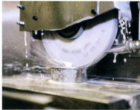
Bild 2. Das BIX Turbo-System erzeugt mehr Volumen im Strahl des Kühlschmierstoffs: entstehende Mikrobläschen kühlen effektiver und halten die Schleifscheibe besser frei von Partikeln.
