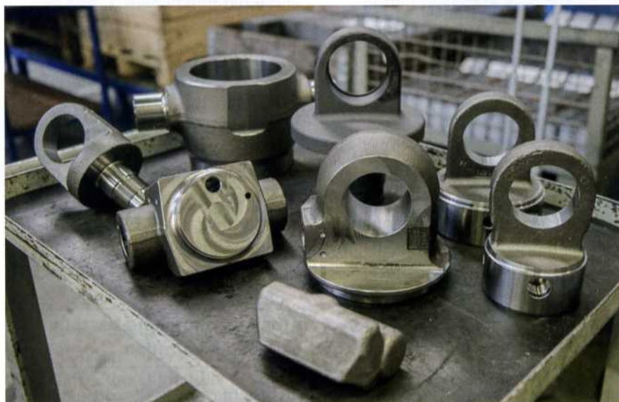
Bild 2: Drei verschiedene Zylinderaugen, vier unterschiedliche Lageraugen, zahlreiche Ventilkörper sowie weitere Elemente der Hydraulikeinrichtung für die Kipper können die Spanntürme aufnehmen
