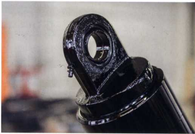
Bild 5: Lageraugen verbinden bei den Meiller Hinterkippern und Kippsattelanhängern die Kippbrücke mit dem Teleskopzylinder
