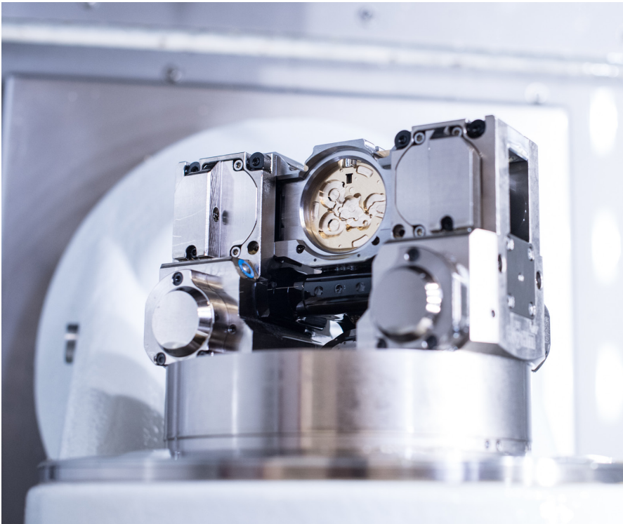
Bild 1: An manchen Stellen wird das Material des Rohlings bis auf 0,5 mm abgetragen
