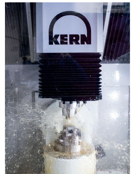
Bild 8: Sogar die Bohrung für die Aufzugswelle kann ohne Umspannen gefertigt werden
