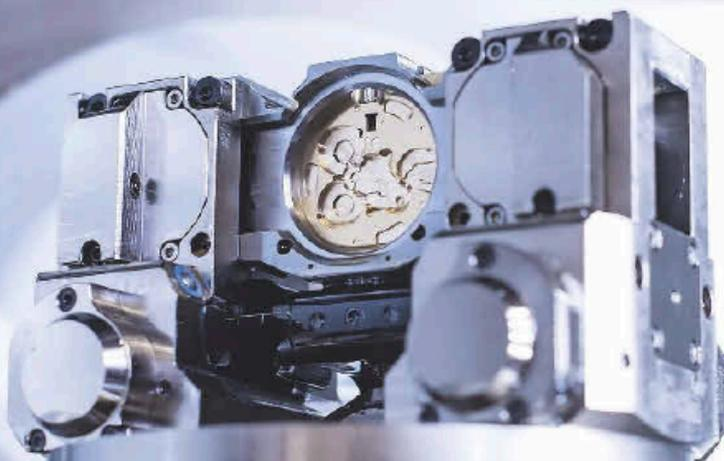
Das Kraftspann-Schwenkfutter von Röhm ermöglicht das Bearbeiten von drei Seiten in einer Spannung. Bilder: Benedict Walther/Röhm
