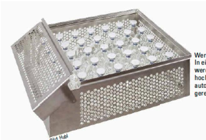
Werkstückträger von Hubl: In einem stapelbaren Blechkorb werden Glasampullen mit hochwertigen Flüssigkeiten automatisch befüllt, transportiert, gereinigt und sterilisiert
