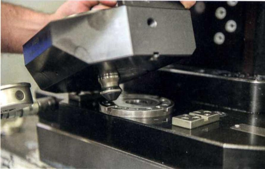
◀ Im Zentrum der Komplettlösung von AMF stehen die bewährten Nullpunktspannsysteme (Bilder: AMF)
