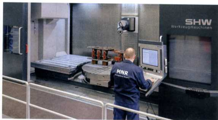
Bild 3. Am vorderen Zugang zum Arbeitsraum ist ein Podest platziert, das den Zugang erleichtert. Der „TightBlock“ nimmt den Rundtisch sowie eine Palettenspannstation mit Anbindung an einen 2-fach-Palettenwechsler auf.
