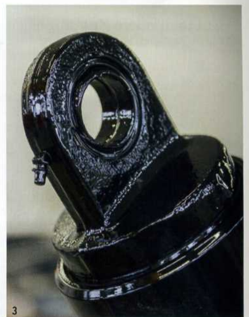
1 Zwei AMF-Spanntürme mit je sechs AMF-Nullpunkt-Spannelementen auf zwei Ebenen vereinfachen die Rüstvorgänge. 2 Die Spanntürme können verschiedene Zylinder- und Lageraugen sowie zahlreiche Ventilkörper aufnehmen. 3 Lageraugen verbinden bei Meiller die Kippbrücke mit dem Teleskopzylinder.
