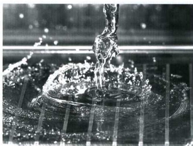
**Bild 2 + 3:** Die BIX-T Einheit versetzt den durchströmenden Kühlschmierstoff in eine Rotationsbewegung. So haftet der Kühlschmierstoff deutlich besser an dem umströmten Werkstück
