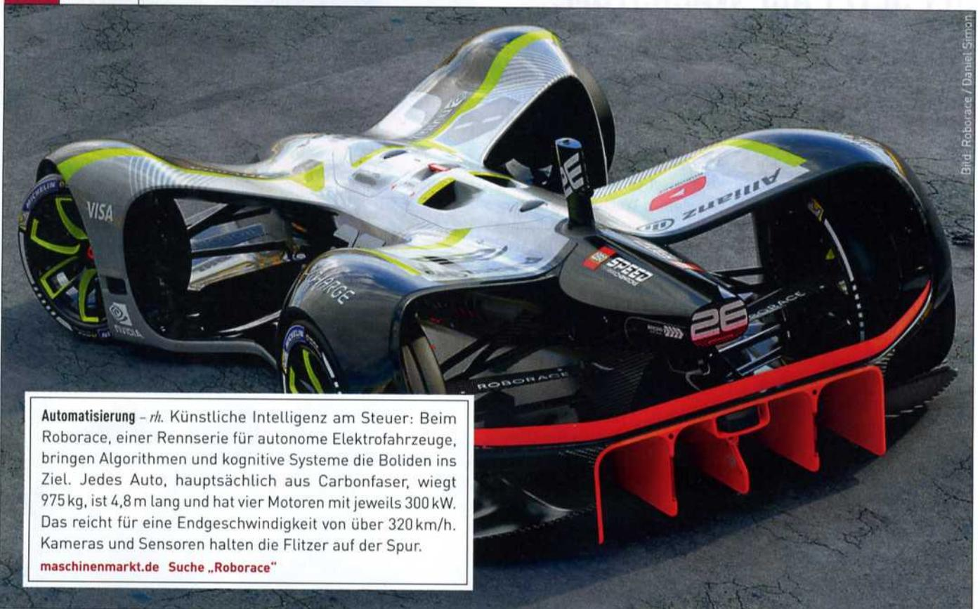
**Automatisierung** – rh. Künstliche Intelligenz am Steuer: Beim Roborace, einer Rennserie für autonome Elektrofahrzeuge, bringen Algorithmen und kognitive Systeme die Boliden ins Ziel. Jedes Auto, hauptsächlich aus Carbonfaser, wiegt 975 kg, ist 4,8 m lang und hat vier Motoren mit jeweils 300 kW. Das reicht für eine Endgeschwindigkeit von über 320 km/h. Kameras und Sensoren halten die Flitzer auf der Spur.
