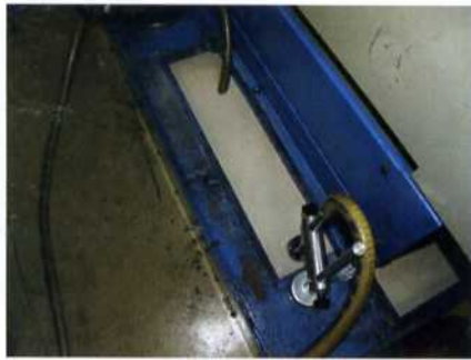
Bild 6: Die Fremddölabscheidung mit dem TM450UV läuft im Bypass-Verfahren während des Maschinenbetriebs
