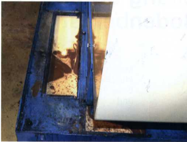
Bild 1: Häufig sind die KSS-Tanks schwer zugänglich und die Reinigung von Emulsion sowie Behälter sehr aufwändig
