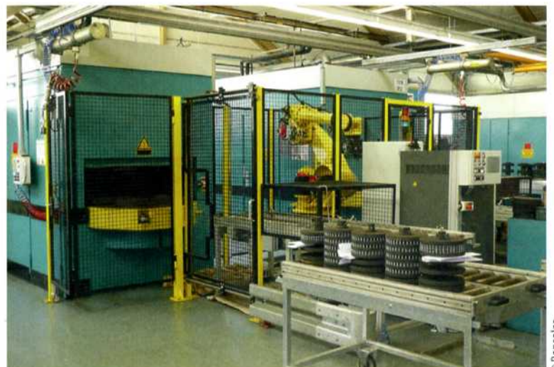
Beim Thermischen Entgraten werden alle am Werkstück vorhandenen Grate in einer Entgratkammer quasi verbrannt.
