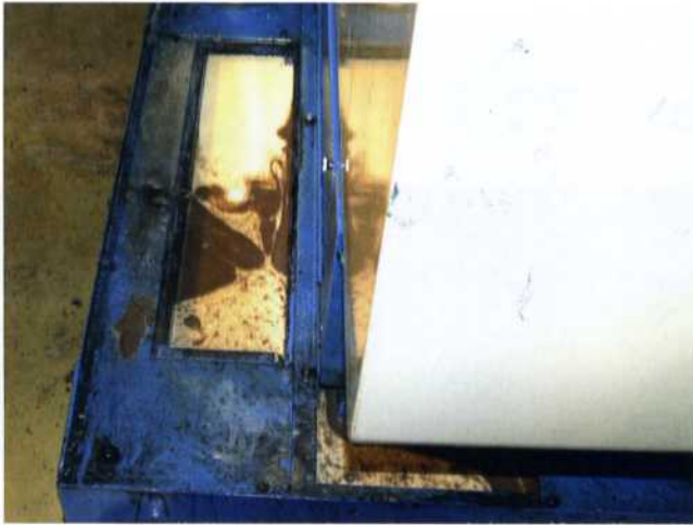
Bild 1: Häufig sind die KSS-Tanks schwer zugänglich und die Reinigung von Emulsion sowie Behälter sehr aufwändig
