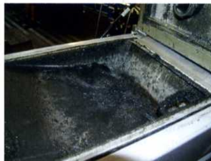
Bild 4: Die abgepumpte Flüssigkeit durchläuft einen Vakuum-Bandfilter, der Feststoffe, Partikel und Späne wirkungsvoll herausfiltert
