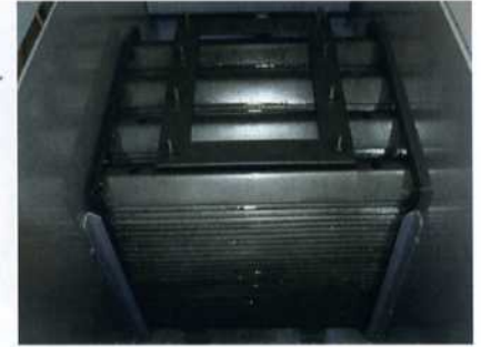
Bild 8: Ein spezielles Koaleszenzpaket entfernt dispers verteilte Öltropfen aus der Emulsion
