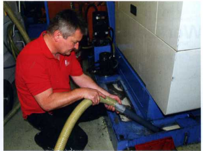
Bild 2: Einfaches Abpumpen mit dem Hochleistungssaug- und Filterwagen SF500
