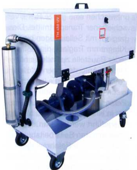
Bild 10: Fremdölabscheidung und UV-Behandlung mit dem TM450UV bereiten KSS und Schneidöle auf und sorgen für längere Werkzeugstandzeiten (Werkbilder: MKR Metzger GmbH, Monheim)
