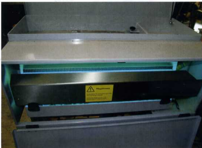
Bild 9: UV-Flachbettreaktoren verbessern Aussehen und Geruch der Prozessmedien markant und unterdrücken wirkungsvoll die Ausbreitung von Mikroorganismen
