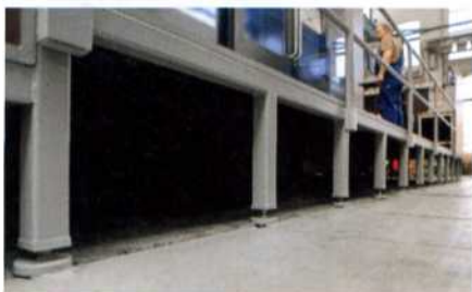
Zum Ausgleich der Höhenunterschiede zwischen Maschine und Aufspanfläche(n) bei flurebener Aufstellung sorgt die neuartige TightBlock Konstruktion von SHW.
