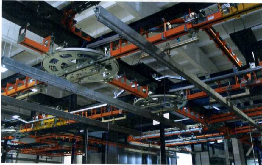
Die Traversen können mit bis zu 1000 kg belastet werden. Sie eignen sich ideal dazu, lange Aluminium-Profile zu transportieren.
