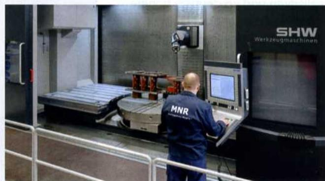
Bild 4: Am vorderen Zugang zum Arbeitsraum des TightBlock wird ein Podest platziert, das den Zugang erleichtert und die Sicht in den Arbeitsraum verbessert
