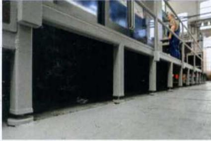
Bild 7: Zum Ausgleich der Höhenunterschiede zwischen Maschine und Aufspannfläche(n) bei flurebener Aufstellung sorgt die neuartige TightBlock Konstruktion von SHW
