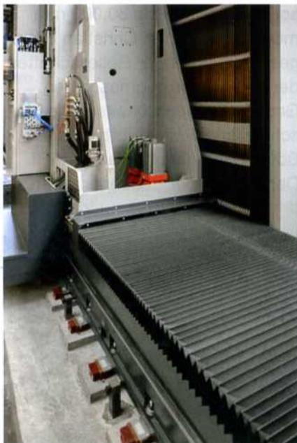
Bild 10: Die Rückseite ist auf der gesamten Länge mit einem Lamellenvorhang geschlossen
