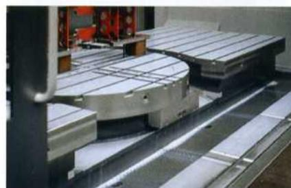
Bild 6: Der TightBlock nimmt den Rundtisch sowie eine Palettenspannstation mit Anbindung an einen 2-fach Palettenwechsler auf
