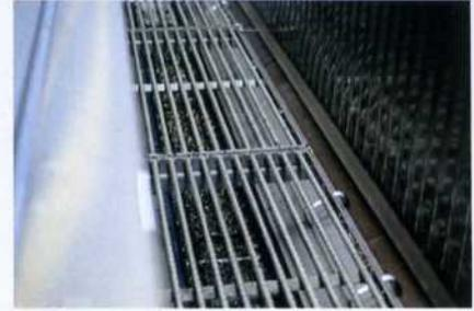
Bild 9: Die PowerSpeed 6 lässt sich bodengleich aufstellen, ohne dass ein Stufenfundament gegossen werden muss
