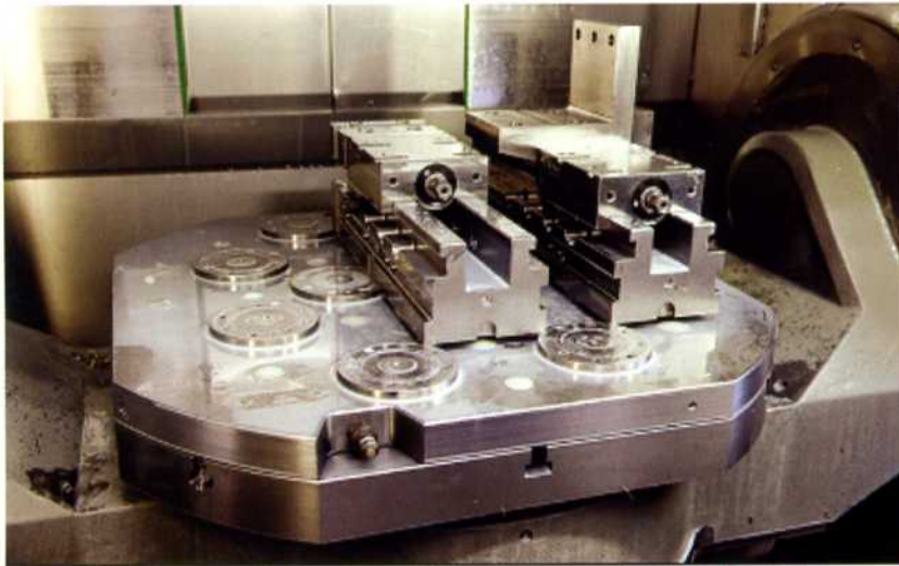
AMF Zero Point Bağlama Sistemi ile Kocher- plastik 3 hedefi yakalamıştır: set up süresini düşürmek, set up' ı basitleştirmek, parça bağlama işini makina dışında yapmak.
