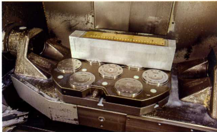
AMF Zero Point Sistemi bağlama modülü K20 kocher plastik'te makinaların daha uzun süre çalışmasını sağlamaktadır.
