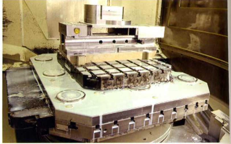
Güçlü ve kompakt gömülebilen bağlama modülleri 55 kN tutma gücüne sahiptir.
