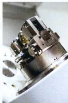
Eine Art Spannloch, das durch die Schwerkraft rotiert, kann nach dem Schwenk des Futters um 180° wiederum von unten abstützen.
