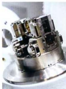
IWC fertigt mit einem Spannfutter von Röhm Uhrenplatinen in einer einzigen Aufspannung.
