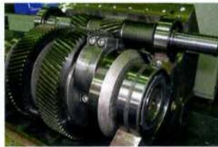
Die Kamat GmbH hat den mechanischen Antriebsstrang ihrer Triplex-Plungerpumpen für Drücke bis 3500 bar grundlegend überarbeitet. Die Pumpen sollen dadurch leiser arbeiten und die Antriebe weniger Energie verbrauchen – insbesondere, wenn sie mit einer Drehzahlregelung kombiniert werden.
