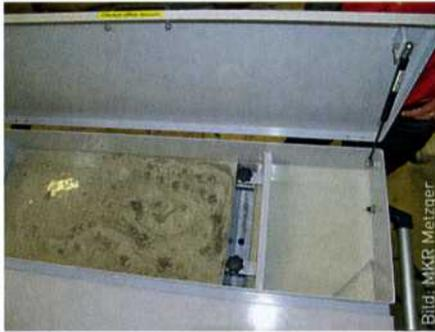
Die Fremddölabscheidung läuft im Bypass-Verfahren während des Maschinenbetriebs.
