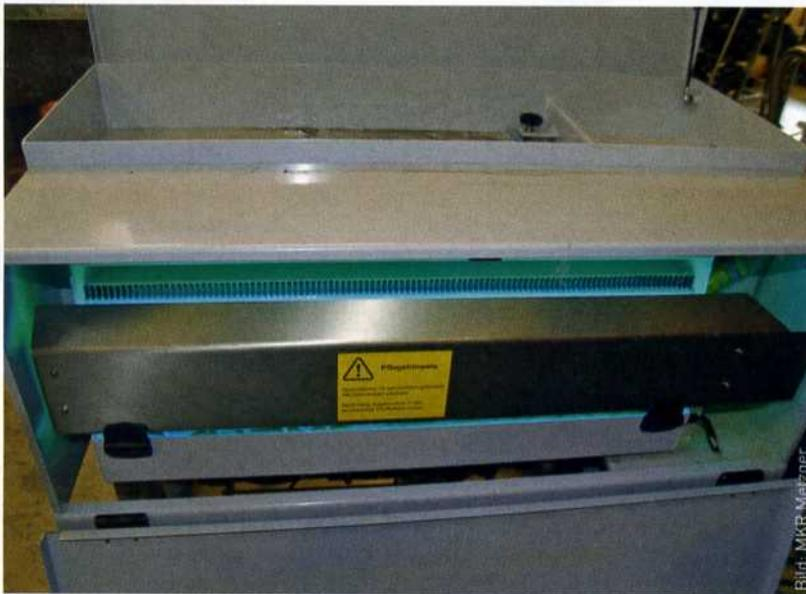
UV-Flachbettreaktoren verbessern Aussehen und Geruch der Prozessmedien markant und unterdrücken wirkungsvoll die Ausbreitung von Mikroorganismen.
