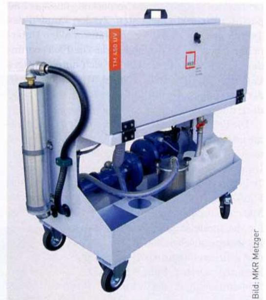
Fremdölabscheidung und UV-Behandlung mit dem TM450UV von MKR Metzger bereiten KSS und Schneidöle auf und sorgen für längere Werkzeugstandzeiten.
