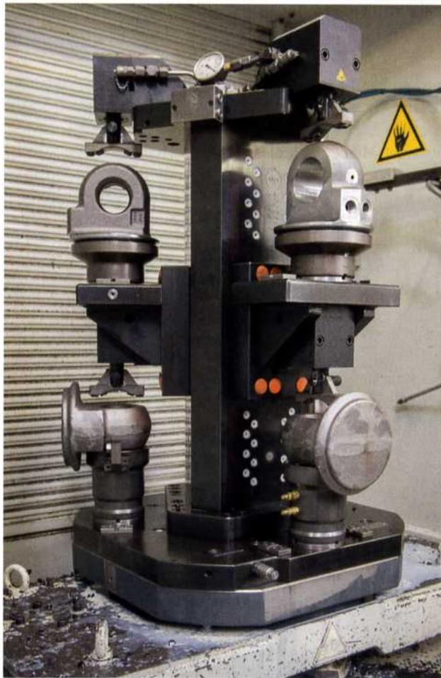
2 Zwei AMF-Spanntürme mit je sechs AMF-Nullpunktspannelementen auf zwei Ebenen vereinfachen das Rüsten; von oben werden die Werkstücke mit einem Druckstück hydraulisch fixiert
