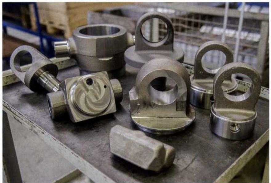
4 Drei verschiedene Zylinderaugen, vier unterschiedliche Lageraugen, zahlreiche Ventilkörper sowie weitere Elemente der Hydraulikeinrichtung für die Kipper können die Spanntürme aufnehmen [© AMF, F.X.Meiller]
